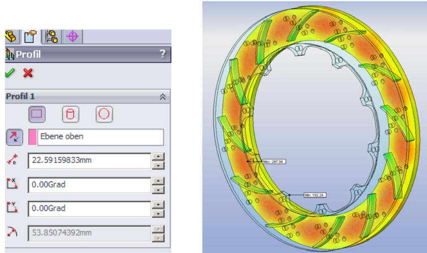
Nutzen Sie ruhig auch mal die radial verlaufenden Trennlinien, um sich den Temperaturverlauf auf Vorder- und Rückseite entlang dieser künstlichen Kanten, wie wir es bereits in vorigen Beispielen durchgeführt haben, als x-y-Diagramm anzeigen zu lassen.
